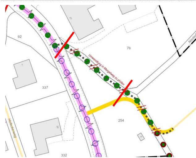
Abb. 8: Abschnitt Rückbau in Mergelweg
